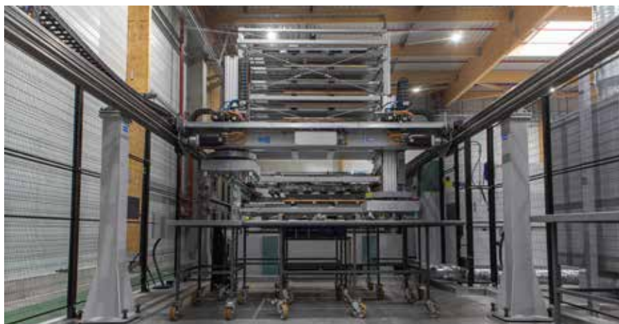
Le manipulateur cartésien de Salvagnini permet de déposer les pièces sur différents types de supports au sein de la zone, ce qui a permis au groupe Atlantic d'opter pour des tables personnalisées.
